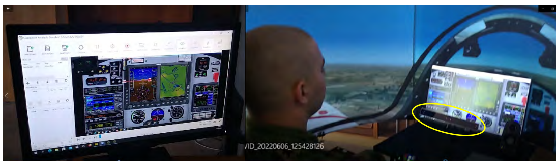
Slika 1 Trenažer aviona Lasta korišćen za potrebe proučavanja Strategije osmatranja instrumenata u digitalnom kokpitu (desno) sa uređajem za snimanje pokreta oka (zaokružen žutom bojom) i kontrolni ekran aplikacije Gazepoint Analysis (levo).
