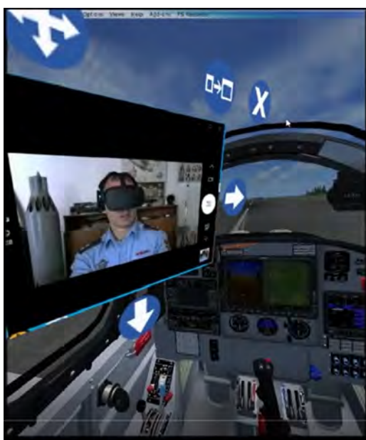
Slika 2 VR Testiranje trenažera aviona Lasta (levo gore) i izgled virtuelnog kabinskog prostora (desno). VR trenažer korišćen za eksperimentalnu grupu ispitanika za pri proučavanju strategija osmatranja instrumenata. Slika iz mešane realnosti softvera FlyInside FlyInside Inc. 2018 .
