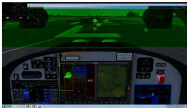
Slika 12 Izgled kokpita aviona Lasta u Microsoft Flight Simulator i 4 AOi za koje je sniman raspored skeniranja instrumenata u radu Vlačić i ostali [12] http://creativecommons.org/licenses/by/4.0/ .
